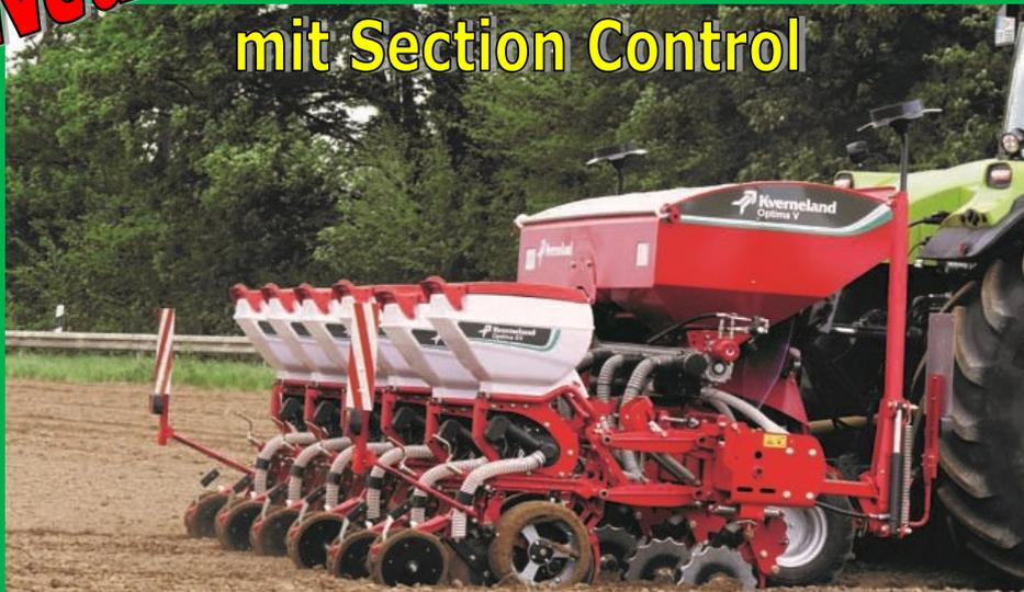
Mit Sektion Control wird jede Pflanzenreihe automatisch über GPS am Saatende abgestellt, somit werden keine Pflanzen ineinander gesät.
